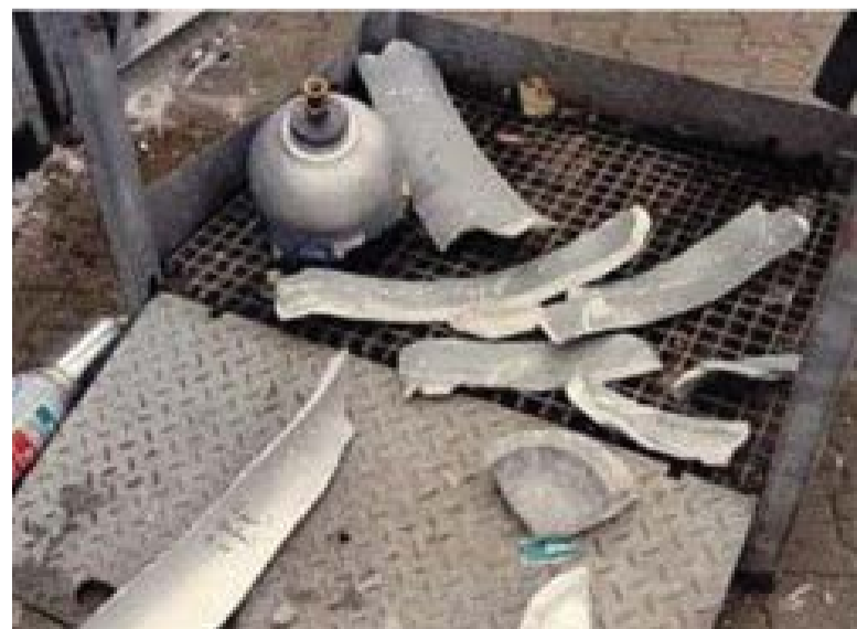
Figura 3. Esplosione di bombola di idrogeno
