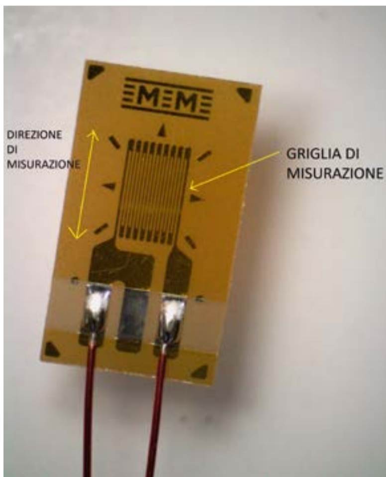
Figura 1. Esemplare di estensimetro monodirezionale, ossia in grado di misurare la deformazione nella direzione evidenziata dalla doppia freccia gialla (per gentile concessione di Luchsinger srl)
