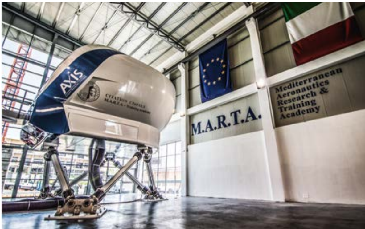
Il simulatore di volo Full Motion del Cessna Citation C560 XLS
