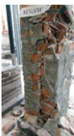
FIGURA 4. Alcune fasi di test eseguite per verificare: a) un innovativo sistema di connessione per pannelli in Xlam; b) l'efficacia di interventi di rinforzo innovativi su colonne in muratura esistenti.
