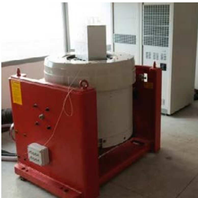
FIGURA 6. Le due tavole vibranti connesse meccanicamente tra loro.
