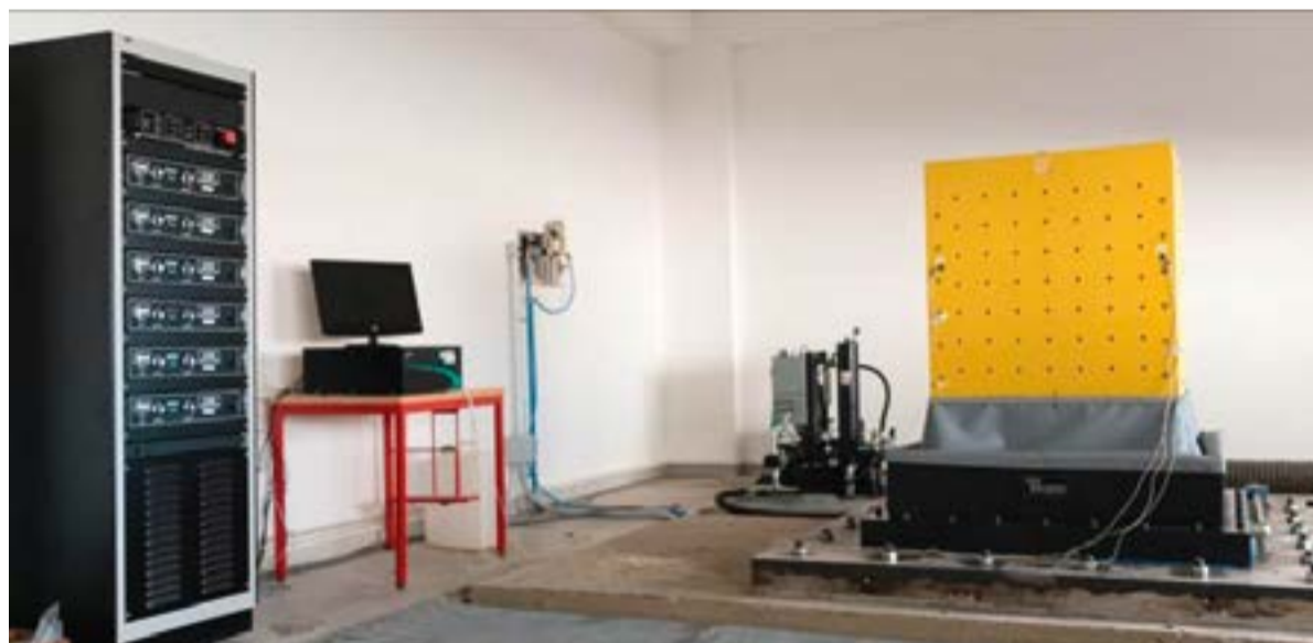
FIGURA 7. Attrezzature di prova della sezione di "Alta dinamica"; a) sopra: banco prova oleodinamico a sei gradi di libertà; b) in alto: shaker elettromeccanico uni-assiale.
