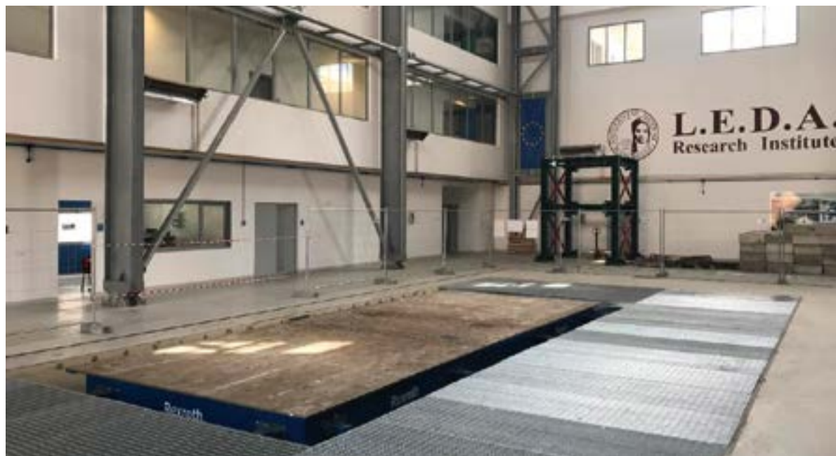
FIGURA 6. Le due tavole vibranti connesse meccanicamente tra loro.
