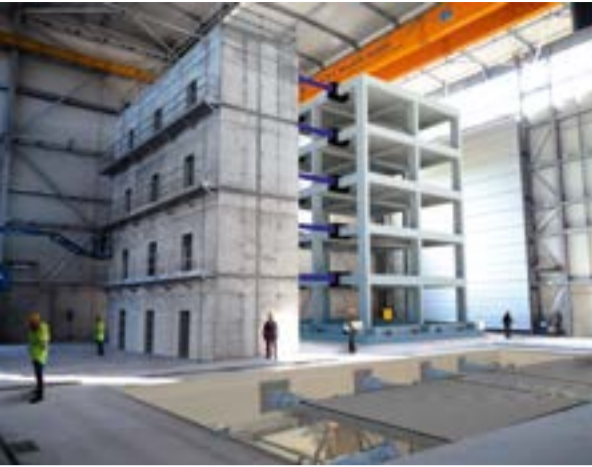
FIGURA 3. Fotoinserimento di una prova sperimentale per la verifica della risposta a sollecitazioni sismiche di una struttura in scala reale utilizzando il sistema di contrasto del Laboratorio Strutture del Centro L.E.D.A. (fotoinserimento eseguito per mostrare le piene potenzialità del sistema di contrasto).
