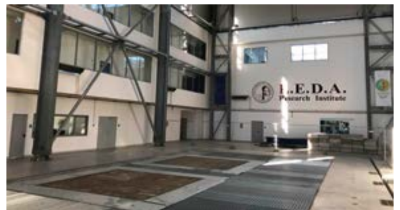
FIGURA 5. Sistema di due tavole vibranti.
