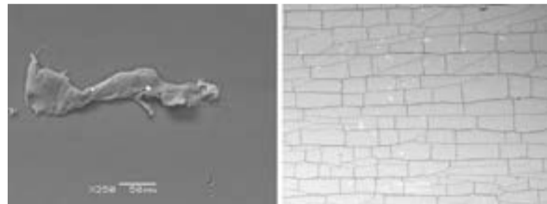
PE-RT. SX: Tubo nuovo (350X) DX: Tubo invecchiato 8 settimane (35X).
