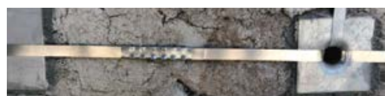
Fig. 2 - Sigillo innovativo, da progetto (in alto) e posto in opera (in basso), che viene chiuso dall'apparecchiatura ideata e realizzata nell'ambito del progetto
