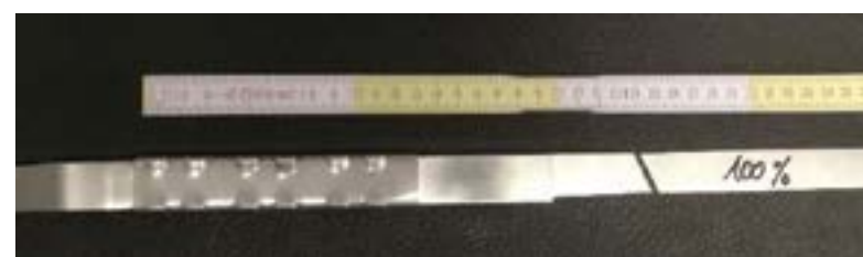
Fig. 3 - Prova di trazione spinta fino alla rottura del nuovo sistema di unione - Grafico forza spostamento (in alto) e foto del campione (in basso) dopo la prova in cui si rileva il punto di rottura del nastro (cerchio rosso) in una zona esterna a quella di unione dei lembi
