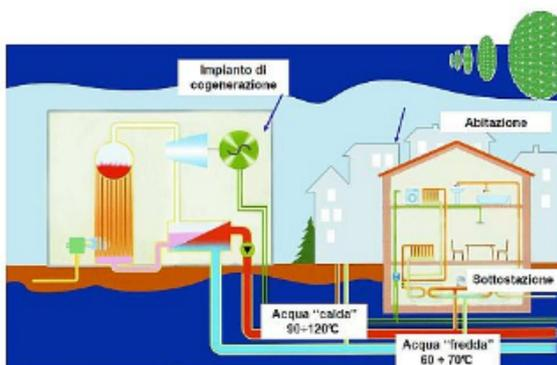
Il calore prodotto dalla centrale termica è trasferito mediante una rete di distribuzione a circuito chiuso ai fabbricati serviti dalla rete; la cessione del calore avviene nelle "sottostazioni di scambio termico" costituite da uno scambiatore di calore e dai relativi dispositivi di sicurezza e protezione previsti dalla normativa vigente.
