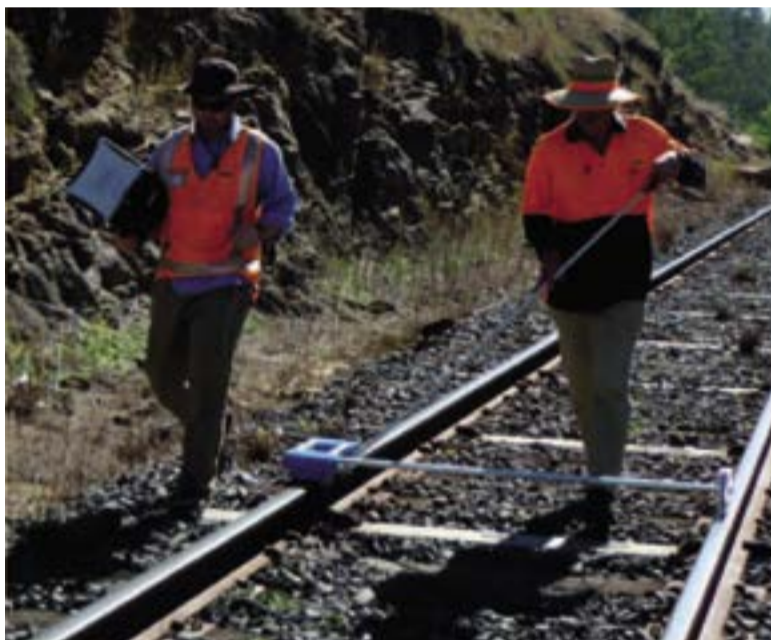
Figura 4. Un moderno "mazzimetro" per la misurazione continua sulle rotaie
