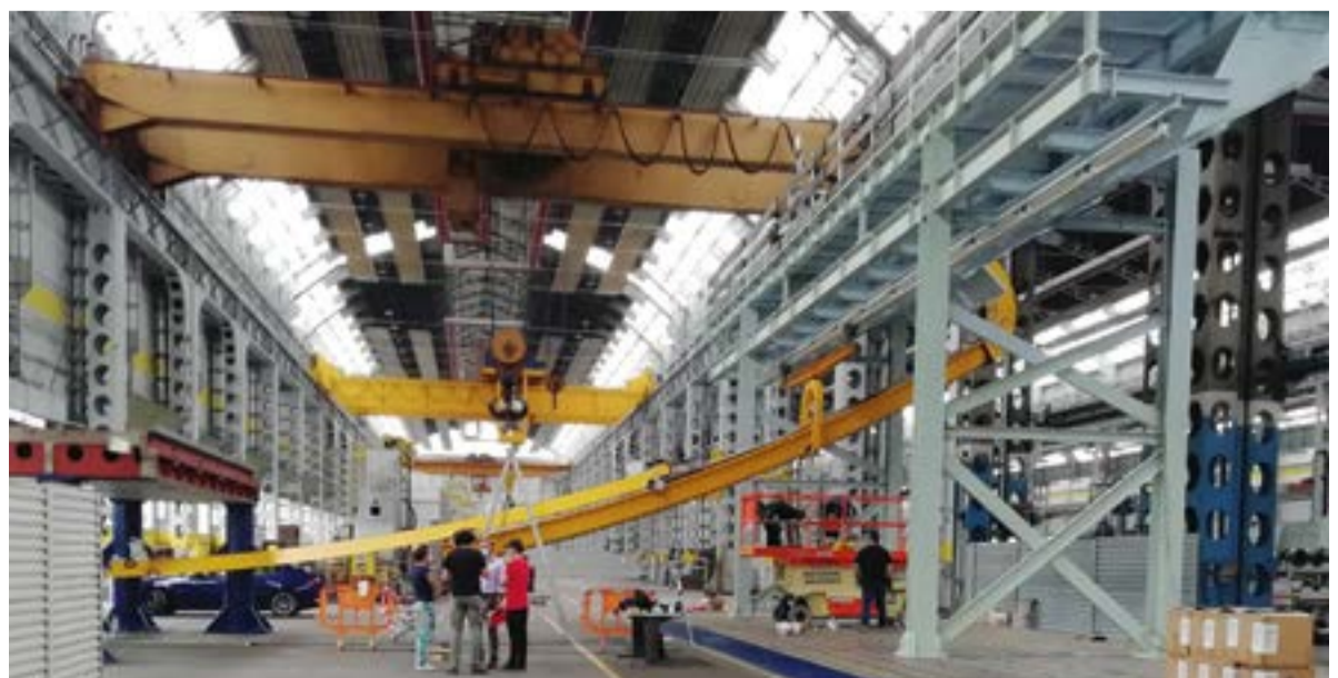
Braccio meccanico estensibile del robot-inspection (immagine fornita da IIT - Camozzi).
