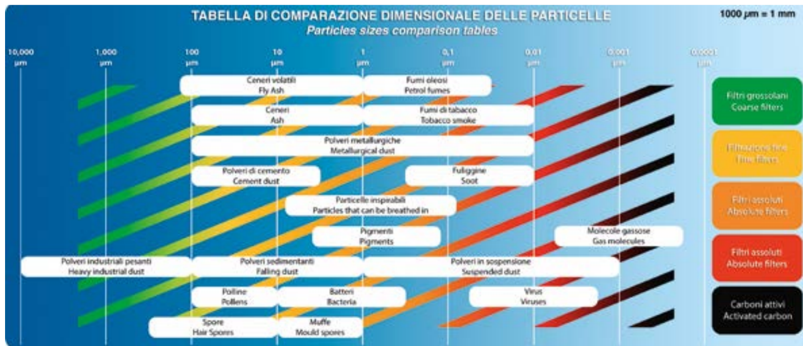
FIGURA 1. La capacità filtrante di diverse tipologie di filtri
