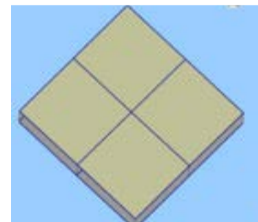
FIG 4.1. Il Modulo MAS_2 (2.4 *2.4 *0.2) m è il modulo ridotto in pianta su cui si andranno a effettuare le prove sperimentali a carico ultimo. Viene conservato lo spessore, per mantenere le saldature in scala 1:1.
