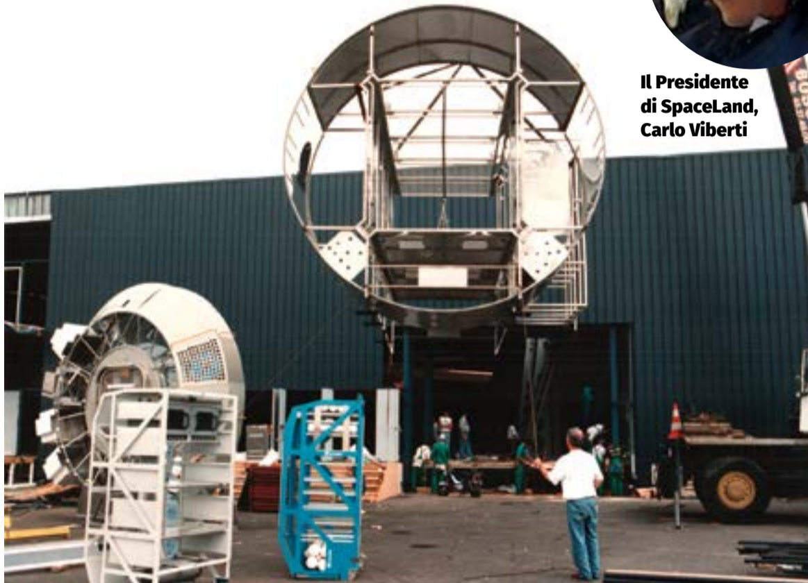
Modello del laboratorio spaziale europeo per prove in gravità zero sott'acqua, progettato dall'ing. Viberti per l'Agenzia Spaziale Europea
