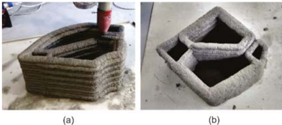
Fig. 1. (a) Processo di stampa in atto e (b) un sottoprodotto cementizio
